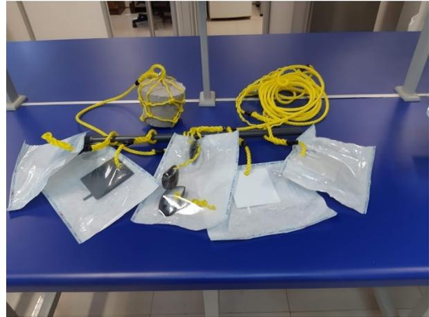
Figura 6-19. Cuelga que fue utilizada para disponer diversos polímeros y conchas de chorito en el centro de cultivo. Cada material fue previamente limpiado, desinfectado y esterilizado mediante UV y luego protegido mediante un embalaje utilizado para autoclave.
