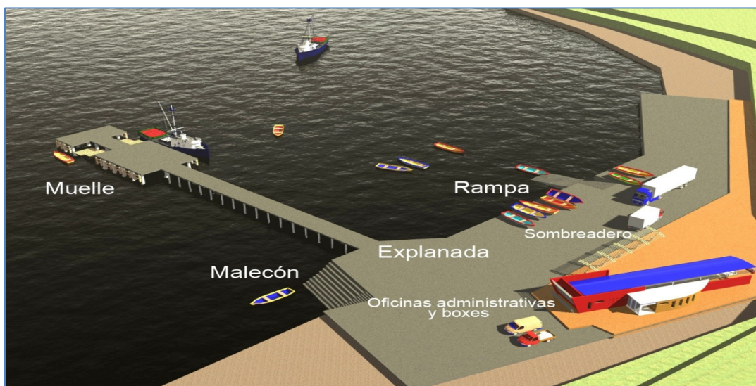
Figura 1: Obras Marítimas y Terrestres básicas
