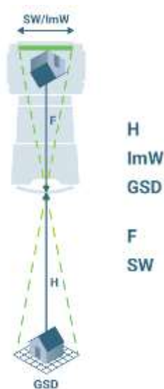
Ilustración 1: Esquema para cálculo de GSD (extraído de Pix4D, 2020)
