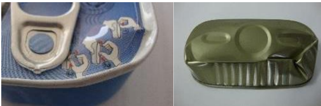
Imagem 135: Recipientes amassados e comprometimento da integridade da embalagem.
