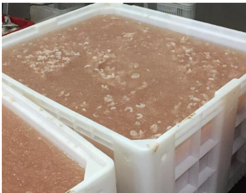
Imagem 33: Prática de oversoaking por meio de banho de imersão em água e gelo com adição de polifosfatos, para causar o encharcamento do camarão (incorporação de água).
