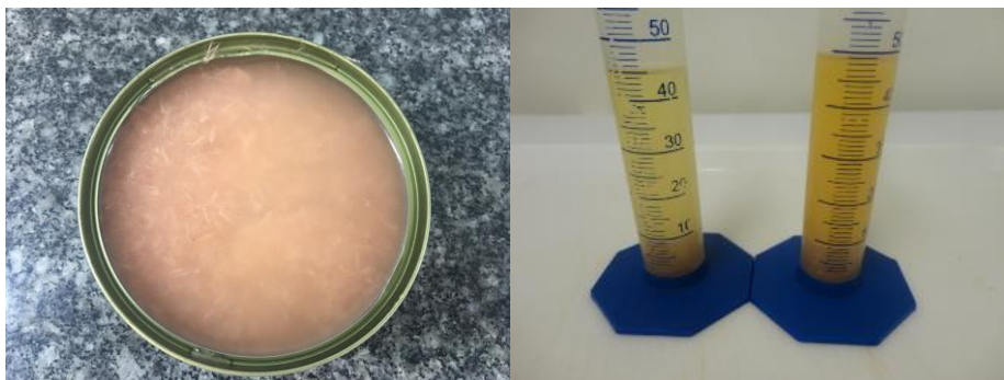
Imagem 138: À esquerda, conserva de atum com indício de excesso de líquido de cobertura. À direita, provetas demonstrando mensuração da quantidade de líquido de cobertura. Este procedimento é necessário para calcular o percentual de líquido de cobertura em relação ao peso líquido declarado.
