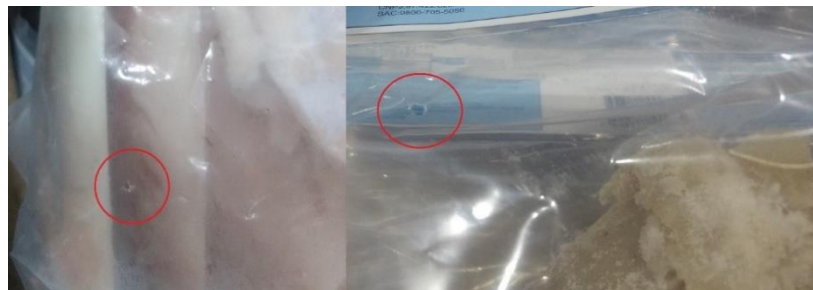
Imagem 17: Embalagens primárias de peixe congelado e salgado danificadas (furos indicados pelos círculos).
